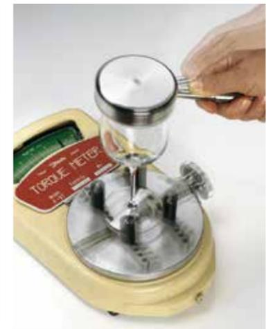
Prova resistenza stelo alla torsione
